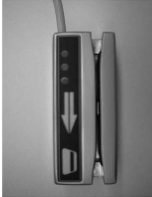
Los Cabezales lectores pueden instalarse separado de la CPU hasta una distancia máxima de 10 metros si se utiliza un cable normal para comunicaciones (manguera de ocho conductores y malla) o hasta una distancia máxima de 20 metros siempre que el cable utilizado sea de pares trenzados con malla (STP) como el DIGILENE modelo COMPUTER A7C4 o el Belden modelo 1588 o cables similares.
