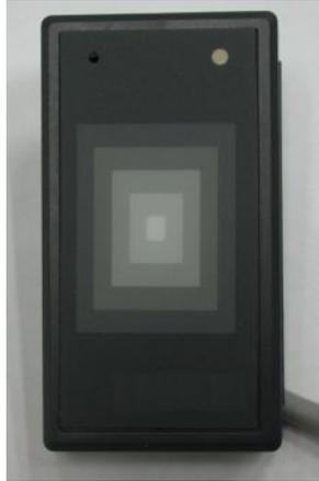
El Cabezal lector puede instalarse separado de la CPU hasta una distancia máxima de 10 metros si se utiliza un cable normal para comunicaciones (manguera de ocho conductores y malla) o hasta una distancia máxima de 100 metros siempre que el cable utilizado sea de pares trenzados con malla (STP) como el DIGILENE modelo COMPUTER A7C4 o el Belden modelo 1588 o cables similares.
