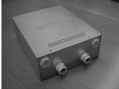
La CPU puede funcionar a temperatura entre 0 y 45 grados C y con una humedad máxima del 95% sin condensación.
