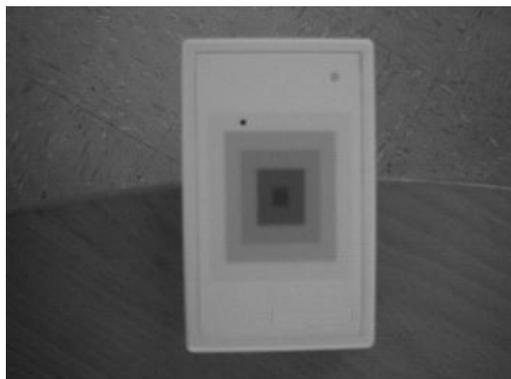
El Cabezal lector puede instalarse separado de la CPU hasta una distancia máxima de 10 metros si se utiliza un cable normal para comunicaciones (manguera de ocho conductores y malla) o hasta una distancia máxima de 100 metros siempre que el cable utilizado sea de pares trenzados con malla (STP) como el DIGILENE modelo COMPUTER A7C4 o el Belden modelo 1588 o cables similares.
